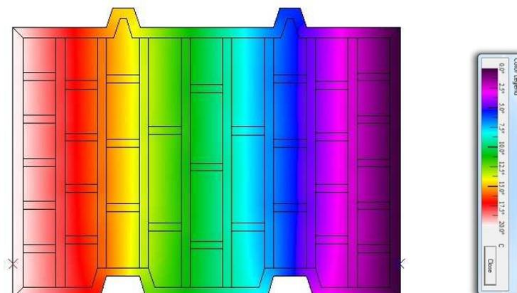
Ai fini del calcolo della trasmittanza della muratura si sono considerati la posa in opera e i valori termici di seguito riportati.
