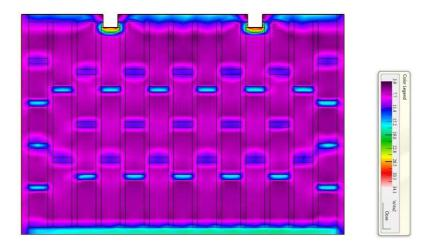
Andamento delle Curve Isoterme all'interno del Mattone [C°]:
